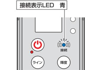
※接続表示LEDが点滅、もしくは非点灯が続く場合は、墨出し器、受光器の電源をOFFにし、再度1から接続設定を行ってください。
