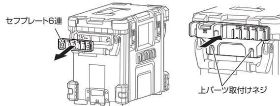
②セフボックス側面の左下のコーナバンパーを取外して、下パーツを同梱の下パーツ取付けネジ2本で固定します。
